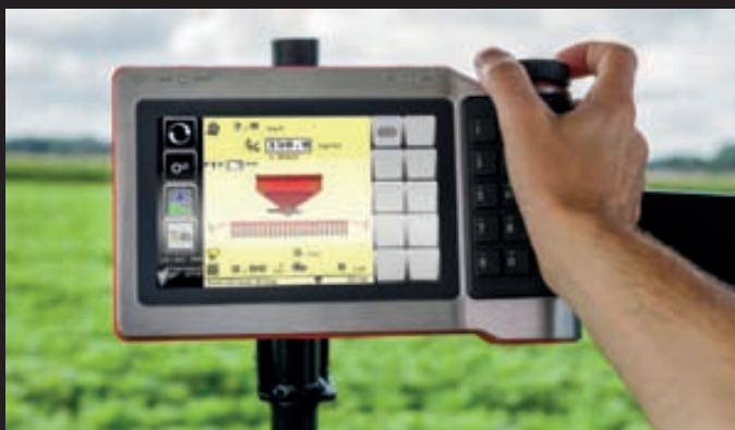
Nyeste ISOBUS kontrolterminal fra Kverneland: IsoMatch Tellus Go med integreret GEOcontrol (GPS styret sektionskontrol).
